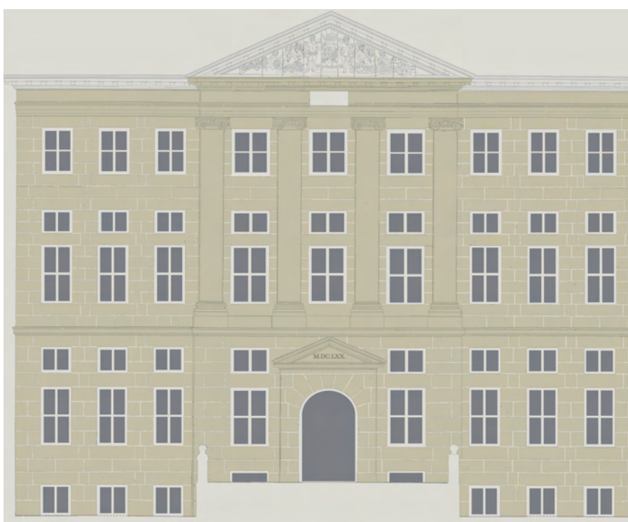
Reconstructie van het visueel bij de bouw bedoelde blokkenpatroon, gebruikmakend van de teruggevonden schijnvoegen. Bij de restauratie zijn deze schijnvoegen ingeschilderd, zodat het blokkenpatroon is hersteld (Erfgoed 's-Hertogenbosch, tekening Ronald Glaudemans).
