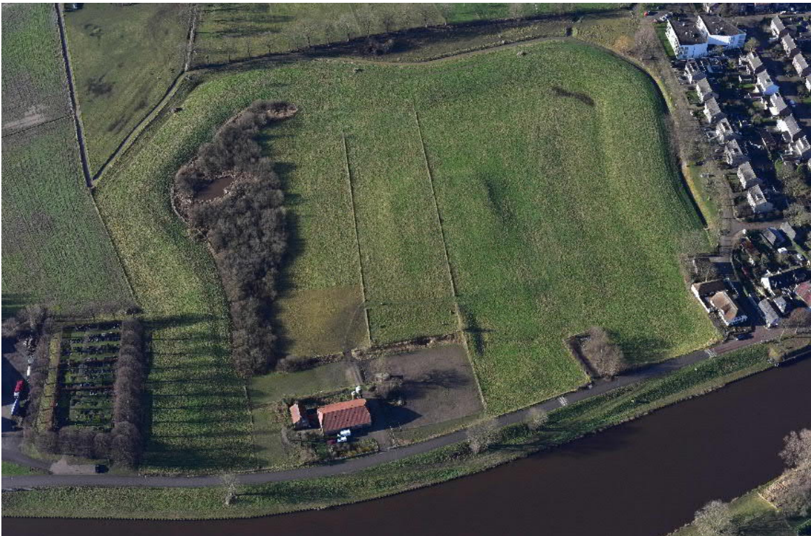
Luchtfoto van de schans bij Engelen. De centrale versterking is vierkant, ongeveer zoals deze door Menno van Coehoorn is ontworpen. De gracht eromheen is nog duidelijk herkenbaar maar staat nu droog.
